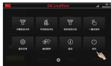
步骤3: 进入倒计时提示，“请确认是否关机”，点击“确定”进入软关机状态，点击“返回”取消操作，软关机状态关闭屏幕，灯光系统仍然点亮。（软关机状态长按屏幕3秒重新启动机器）
