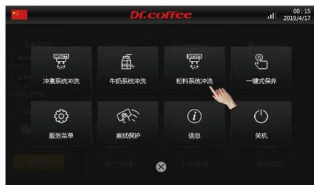
步骤3：根据屏幕提示操作，进行粉料系统冲洗。
