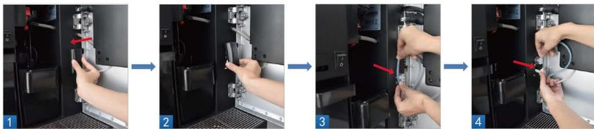
步骤2: 将清洗后的牛奶管装回机器。
