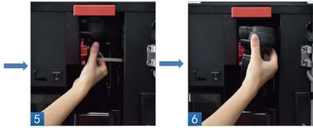
步骤2: 如图将冲洗干净并擦干的搅拌器装回机器中并锁紧, 捏住手柄将锁定装置推进, 直到其停止。
