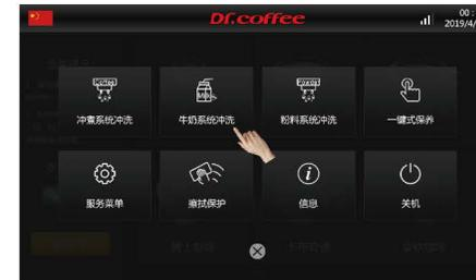
步骤3：根据屏幕提示操作，进行牛奶系统冲洗。
