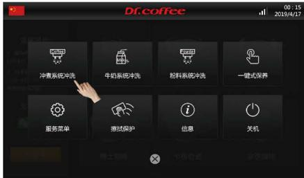
步骤3：根据屏幕提示操作，进行冲煮系统冲洗。
