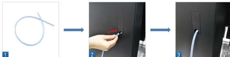
✓ 牛奶管拆装清洗完成
