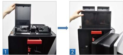
步骤3：捏住手柄将锁定装置推进，直到其停止，关闭咖啡机门并顺时针旋转钥匙锁紧。
