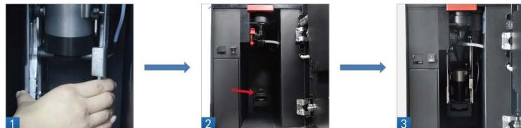
步骤2：将手放在卡托底部，用力向上推起冲泡器直至卡扣到位，然后装回渣盒。
