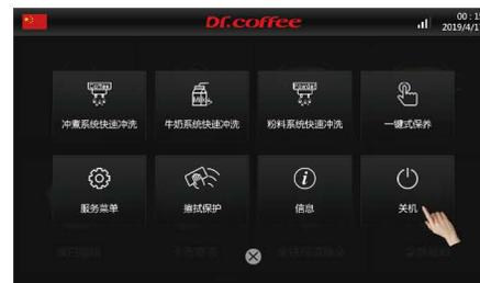
步骤3：屏幕弹窗提示，“请确认是否关机”，点击“确认”进入软关机状态，点击“返回”取消操作，软关机状态关闭屏幕，灯光系统仍然点亮。（软关机状态长按屏幕3秒重新启动机器）
