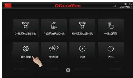
步骤3: 点击“机器维护保养”, 再点击“清空水路”, 根据屏幕提示步骤进行操作, 完成清空水路;
