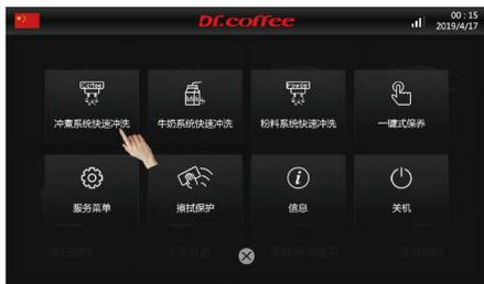
步骤3：根据屏幕提示逐步操作，进行冲煮系统快速冲洗。
