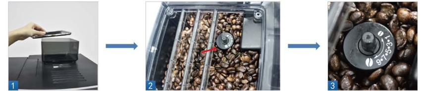
步骤2: 将调节扳手插入旋钮中, 点击屏幕的任意饮品让磨豆机转动起来, 然后适量的转动扳手调至合适的粗细度即可;
