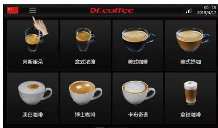
步骤2: 长按3秒“牛奶系统快速冲洗”进入“牛奶系统深度清洗”做深度清洁, 再根据屏幕提示步骤进行操作, 完成牛奶系统深度清洗。
