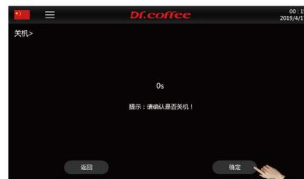
步骤4：在软关机的状态下，按下咖啡机背面电源开关彻底切断咖啡机电源。
