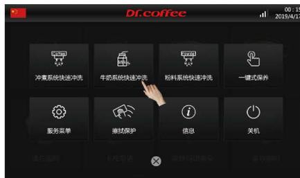
步骤3：根据屏幕提示逐步操作，进行牛奶系统快速冲洗。
