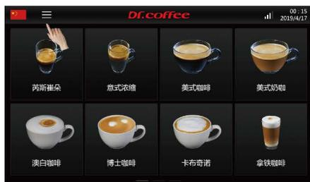
步骤2: 长按3秒“擦拭保护”进入“咖啡机除垢”做深度清洁, 再根据屏幕提示步骤进行操作, 完成咖啡机除垢。
