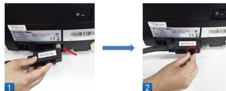
步骤3：将咖啡机连接管线另一端对准冰箱左侧接头，先将白色连接器对插好，再黑色接头插到位，最后旋紧黑色螺钉；
