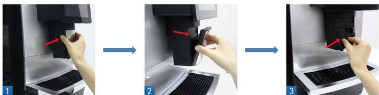
步骤3：将奶沫器里的接头与硅胶部件拔出，拿至水龙头下冲洗干净；
