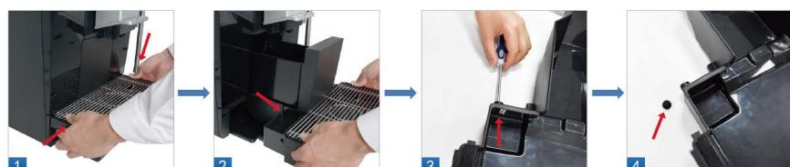
步骤2：安装止逆阀；（安装此部件后必须安装废水管，否则废水会泄漏在机器内）
