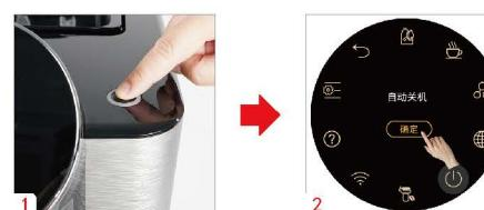
步骤2：在软关机的状态下，按下咖啡机背面电源开关彻底切断咖啡机电源。
