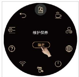
步骤5：根据屏幕提示操作，进行冲煮系统深度清洗。
