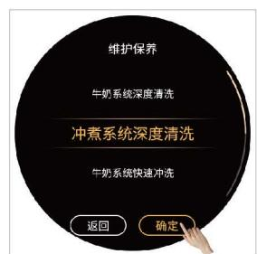
步骤4：进入冲煮系统深度清洗界面，点击确定，进行冲煮系统深度清洗；
