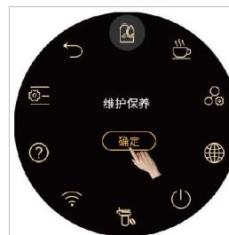
步骤3：屏幕中央滑动到牛奶系统深度清洗，点击确定；
