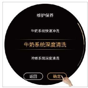
步骤4：进入牛奶系统深度清洗界面，点击确定，进行牛奶系统深度清洗；
