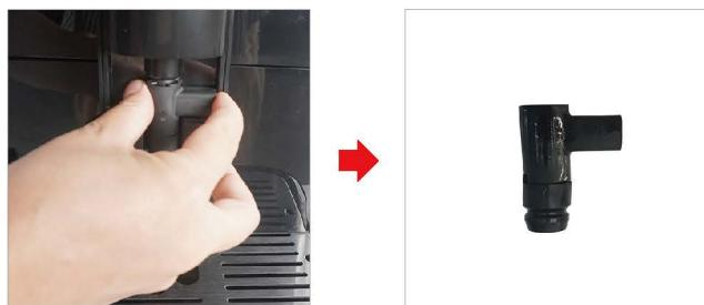
步骤4：将奶沫器、接头等部件全部拆解开，拿至水龙头下清洗；
