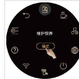
步骤3：屏幕中央滑动到冲煮系统快速冲洗，点击确定；
