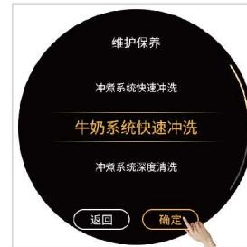
步骤4：进入牛奶系统快速冲洗界面，点击确定，进行牛奶系统快速冲洗。
