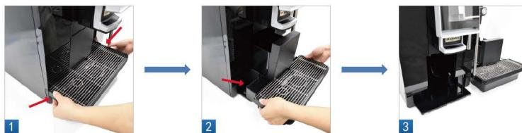
步骤2：如图用手指向里面推卡扣，再向下按压卡托，然后用手抓住冲泡器本体，向外取出冲泡器。
