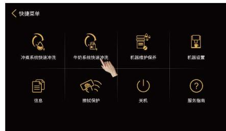
步骤3：根据屏幕提示操作，进行牛奶系统快速冲洗。
