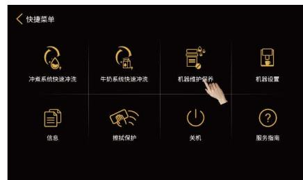
步骤3：点击屏幕中的“牛奶系统深度清洗”，根据屏幕提示逐步操作，进行牛奶系统深度清洗。
