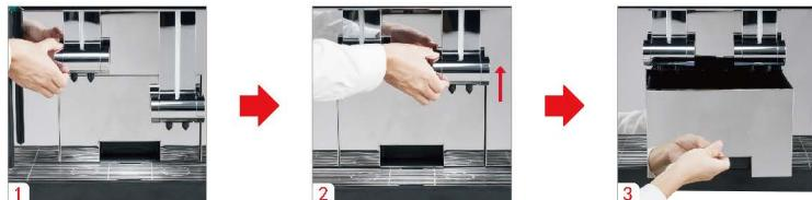
步骤2：如图用手指向里面推卡扣，再向下按压卡托，然后用手抓住冲泡器本体，向外取出冲泡器；
