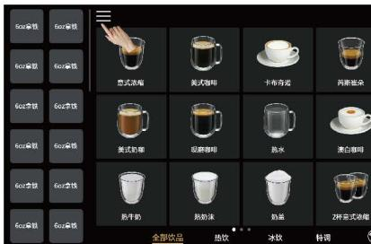
步骤3：点击“机器设置” - “维护设置” - “除垢复位” - “确认”，完成除垢。
