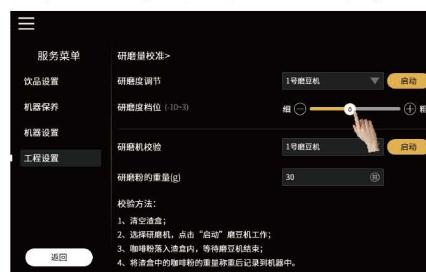
步骤3：点击“启动”，咖啡机进行研磨度调节(完成研磨度档位调节后请进行粉量校准操作后进行饮品制作确认研磨度状态)。
