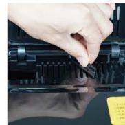
➤ 注意请一定在磨豆机转动时调节旋钮否则可能对机器产生损坏。
