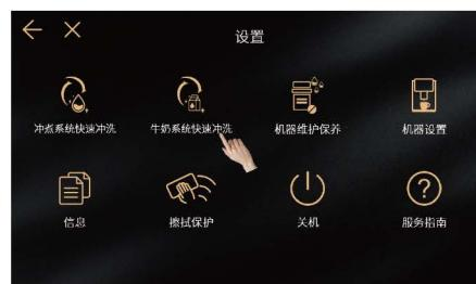
步骤3：根据屏幕提示操作，进行牛奶系统快速冲洗。
