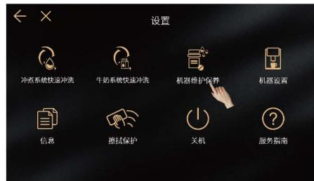
步骤3：点击屏幕中的“除垢”，根据屏幕提示逐步操作，进行咖啡机除垢。
