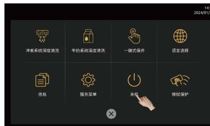
步骤3: 进入倒计时提示, “请确认是否关机”, 点击“确定”进入软关机状态, 点击“取消”取消操作, 软关机状态关闭屏幕, 灯光系统仍然点亮。(软关机状态长按屏幕3秒重新启动机器)
