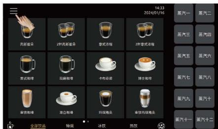
步骤2: 点击屏幕“牛奶系统深度清洗”, 再按照界面提示进行操作。
