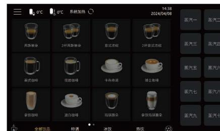
步骤6: 待系统加热完成后, 进入快速冲洗选择界面, 10s内无操作将默认执行快速清洗动作, 完成后将进入主界面。
