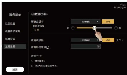
步骤3: 点击“启动”，咖啡机进行研磨度调节(完成研磨度档位调节后请进行粉量校准操作后进行饮品制作确认研磨度状态)。
