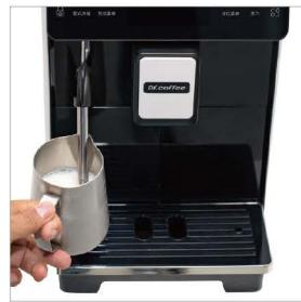
步骤4：制作完成后，点击屏幕上的取消按钮，蒸汽杆停止出蒸汽。
