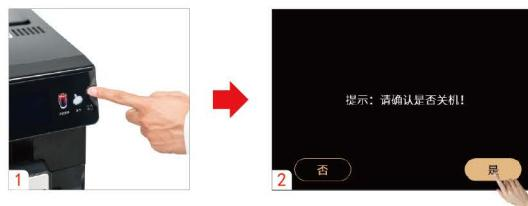
步骤2：在软关机的状态下，按下咖啡机背面电源开关彻底切断咖啡机电源。
