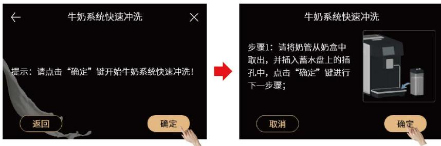
步骤4: 根据屏幕提示操作, 进行牛奶系统快速冲洗。
